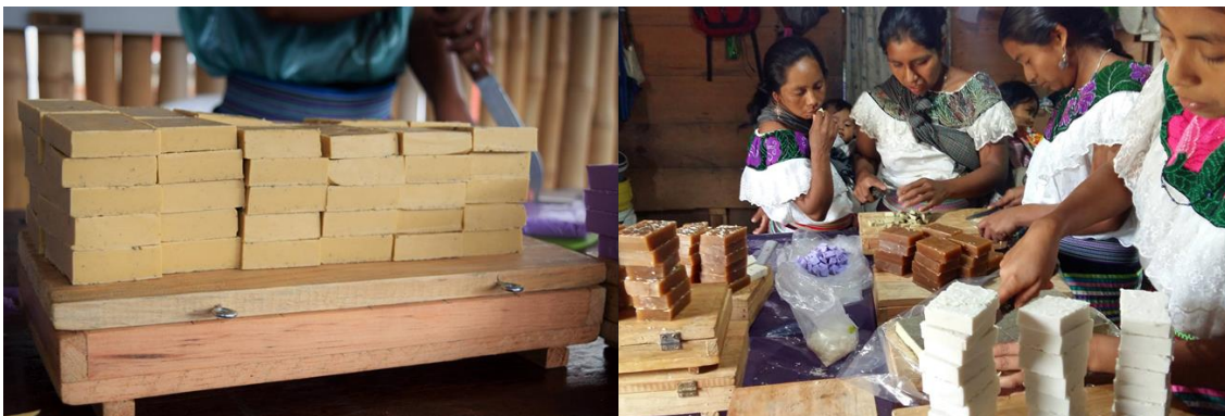
Ilustración 5. Proceso desmoldado, desbordado y corte de la organización Xapontic. Fuente: Xapontic
